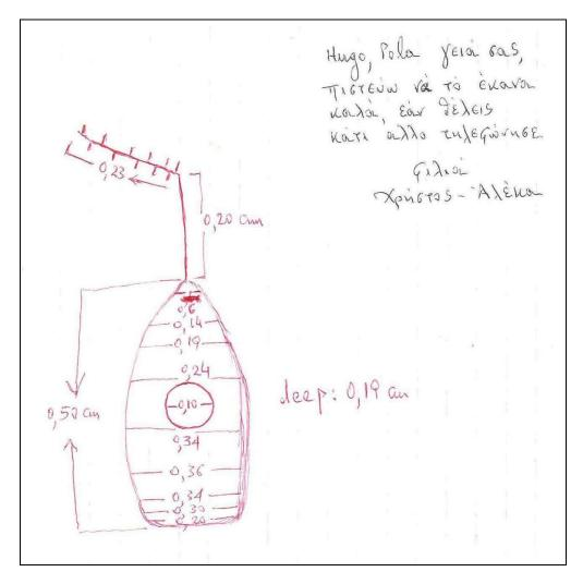
Fig. 4 Technical drawing of oud in Fig. 3 by Χρήστος Πράσσας
